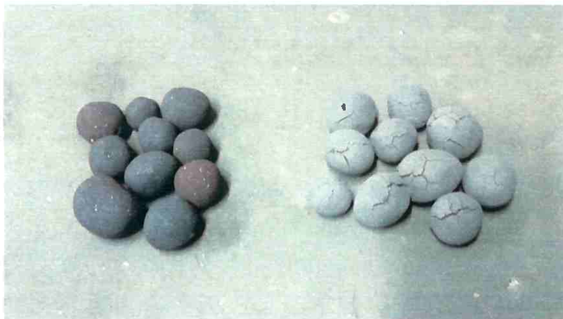
Figura 18 - Comparação entre pelotas queimadas (à esquerda) e pelotas reduzidas à 1000°C (à direita).
